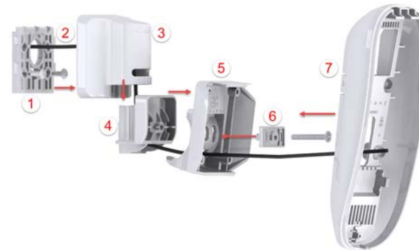
Figura 4: Montaje de la cámara HD77 con soportes giratorios
