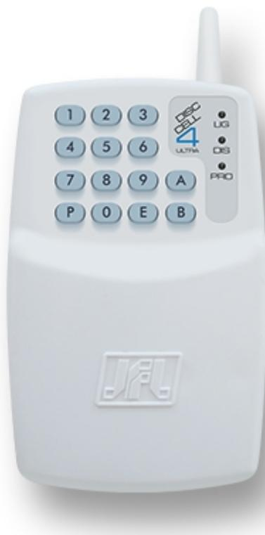
Disc Cell-4 Ultra: Discadora GSM con teclado, marca para hasta 4 números telefónicos.
